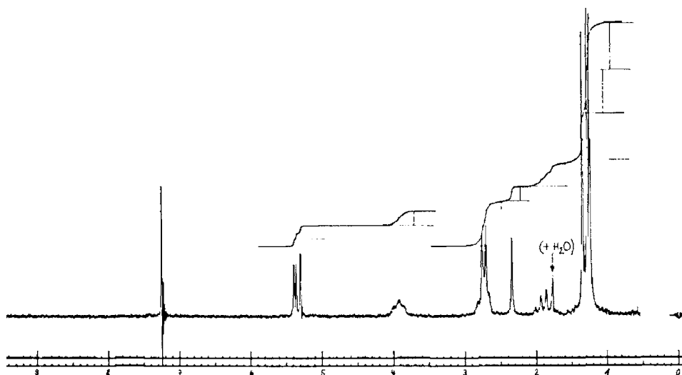
Fig. 55. 1 H-NMR-Spektrum von (Chloro-Zn II )-1-oxosecocorrinat 29 in CDCl 3
